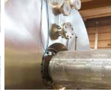
Abstandshalter für Wellendichtungsabnahme
