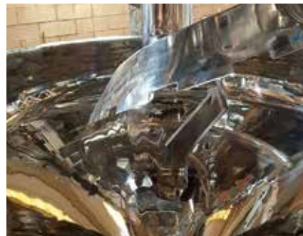
Einzigartiges Doppelspiralrührwerk (voll beheizt)
