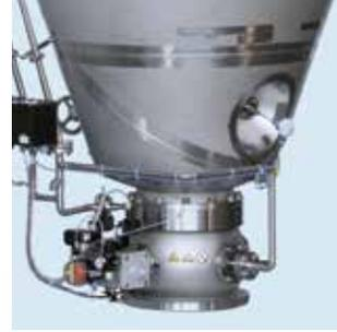
Auslassventil: CIP & Kugel-Segment
