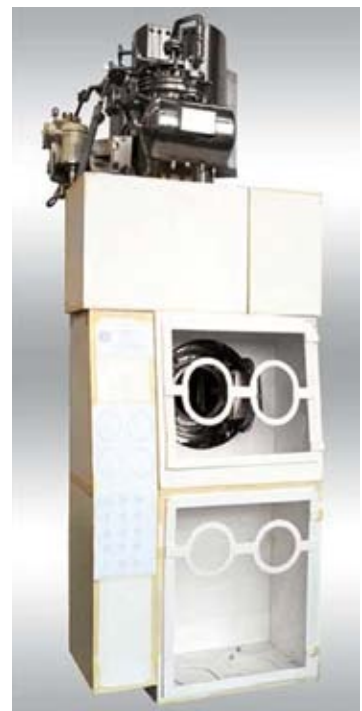
Links und Mitte: Ausführungen zweiteiliger aktiver Isolatoren. Rechts ein Modell (Mock-Up), welches zur Prüfung der Ergonomie vor der Herstellung des Isolators in der Mitte gefertigt wurde.
