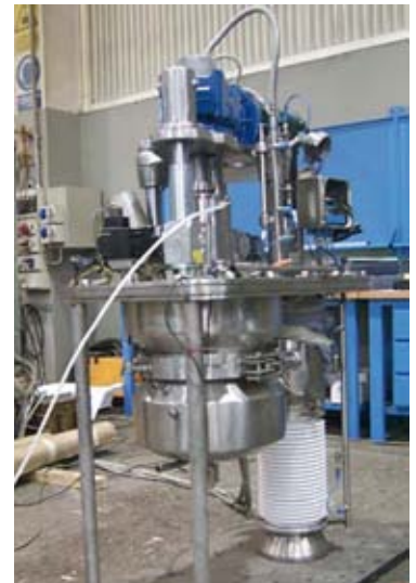
Filter vor Einbau in Isolator
