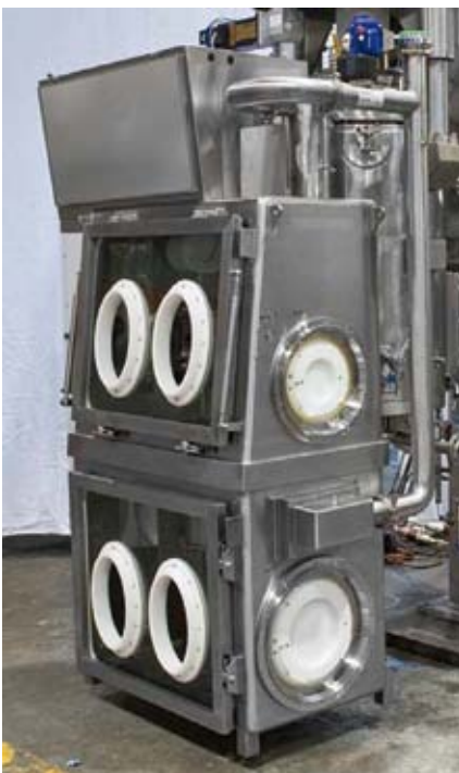
Links und Mitte: Ausführungen zweiteiliger aktiver Isolatoren. Rechts ein Modell (Mock-Up), welches zur Prüfung der Ergonomie vor der Herstellung des Isolators in der Mitte gefertigt wurde.
