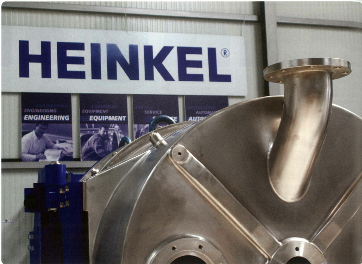
Bild 1: Hier werden gerade StülpfILTERZENTRIFUGEN montiert. Sie werden beispielsweise in der Pharma-industrie eingesetzt.
