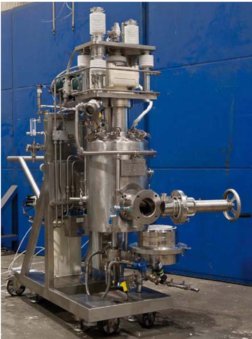
Pressofiltro ® PF 10 mit 0,045 m 2 Filterfläche
