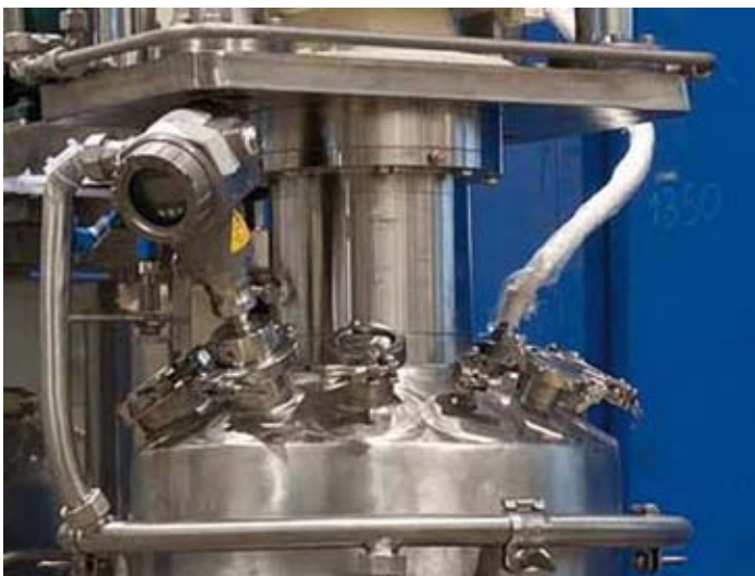
Auf den Abbildungen oben ist eine Pressofiltro® PF 10 Pilotanlage mit 0,045 m 2 Filterfläche dargestellt.
