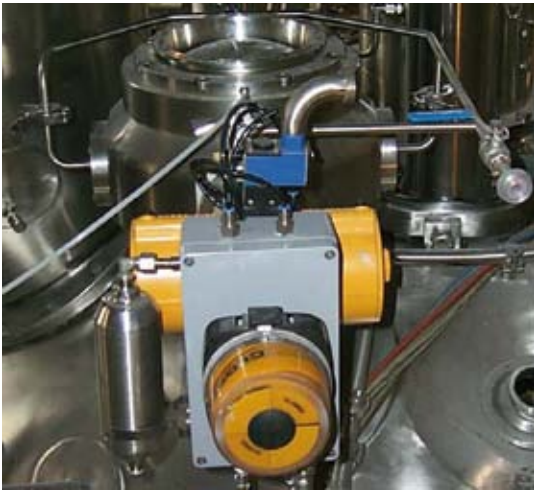
Links: Kugelsegmentventil mit aufblasbarer Dichtung für den Feuchtprodukt-Eintrag, angebracht am Eintragsflansch auf dem Trockner-Oberteil. Als Alternative können hier auch Absperrklappen, z.B. mit PTFE-Auskleidung, eingesetzt werden.
