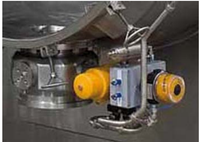
Rechts: Kugelsegmentventil mit aufblasbarer Dichtung für Trockenprodukt-Austrag, angebracht am Behälter-Unterteil. Diese Armaturen sind in Mischbauweise verfügbar, z.B. feuchtproduktbenetzt in Hastelloy, trockenproduktbenetzt in Edelstahl.
